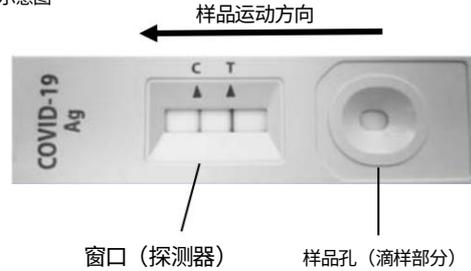
C:控制线 T:测试线
